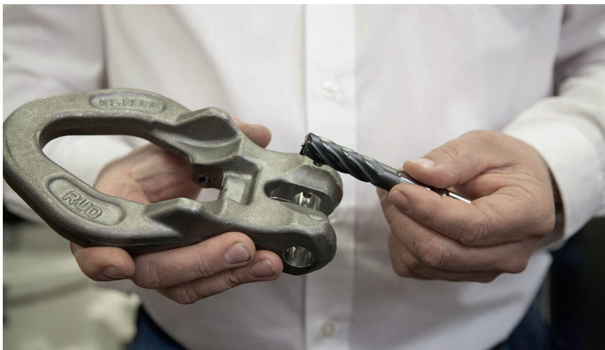
3 Dieser Rohling eines sogenannten Muldeneinhängeglieds (links) wird in einer Aufspannung bearbeitet, die Nut trochoidal ausgeräumt. Der WNT-Fräser (rechts) stellt dabei einen stabilen Prozess sicher bei langer Standzeit (© Ceratizit)
